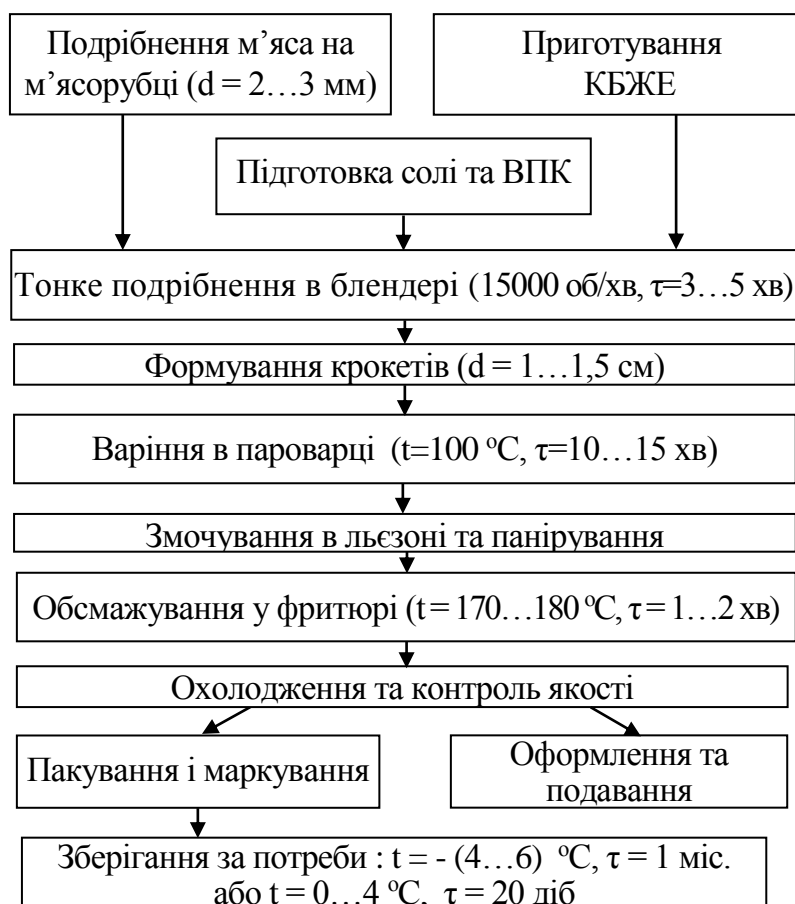
Рис. 7. Принципова схема виготовлення м'ясомістких крокетів з КБЖЕ
