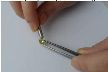
Рисунок 3 – Визначення твердості об'єкта дослідження
