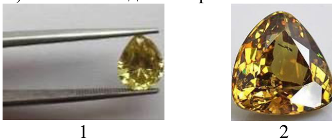
Рисунок 1 – Визначення блиску: 1 – фотографічне зображення об'єкта дослідження; 2 – фотографічне зображення яскравого скляного блиску зразка-еталона
