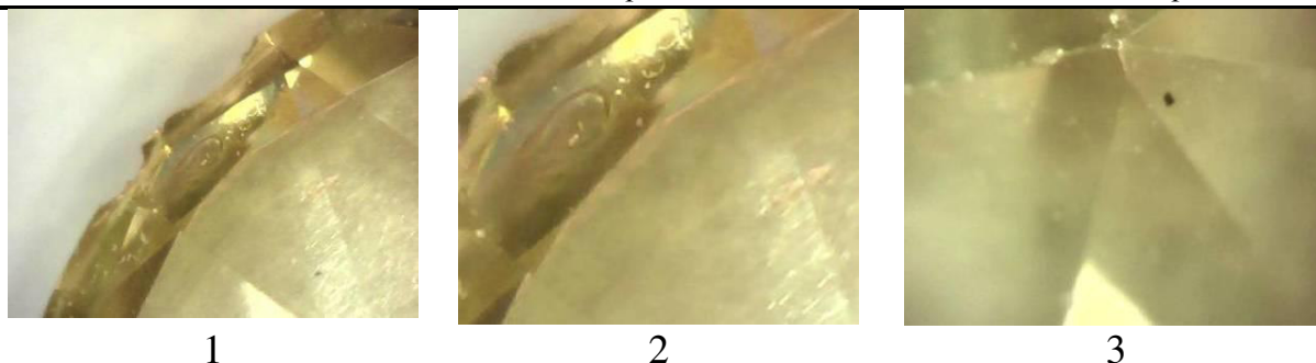
Рисунок 2 – Зображення об'єкта дослідження під мікроскопом (збільшення від 5х до 500х), наявність: 1 – сколів; 2 – бульбашок; 3 – включень
