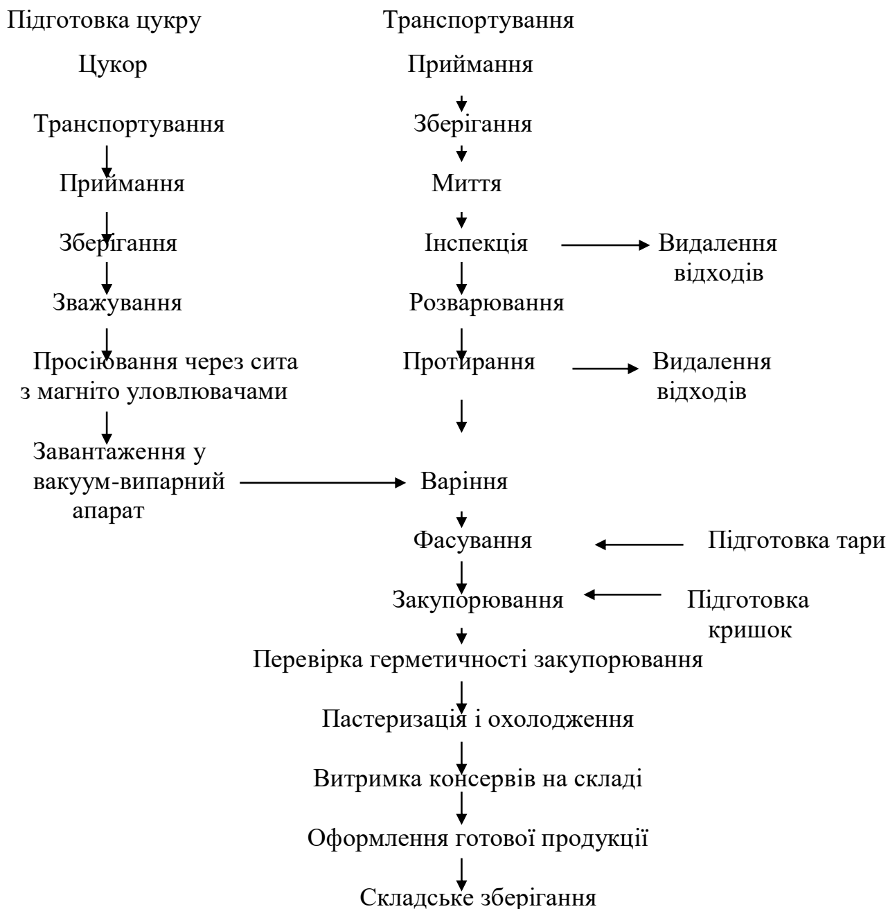
Рисунок 2.2 - Технологічна схема з виробництва консервів «Фруктовий соус з яблук»
