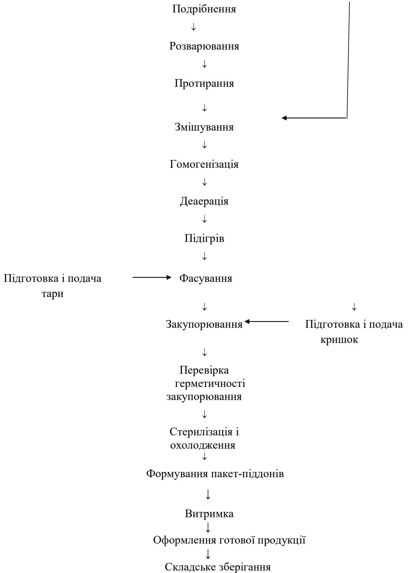
Рисунок 2.2 - Технологічна схема виробництва консервів «Морквяний сік»
