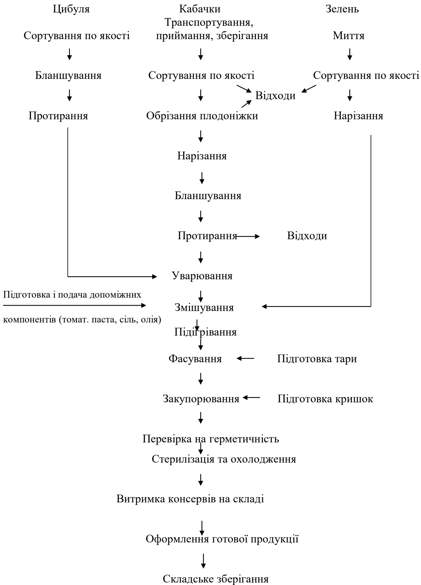
Рисунок 2.2 - Технологічна схема виробництва консервів «Ікра кабачкова»
