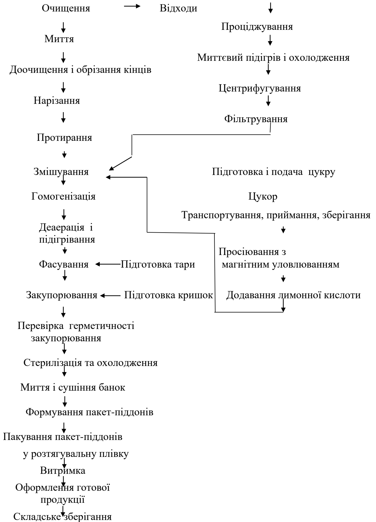
Рис. 2.2. Технологічна схема виробництва консервів «Напій яблучно-буряковий з м'якоттю»
