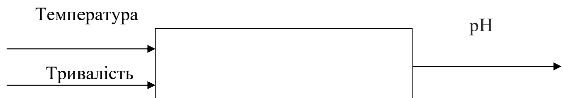
Рис. 2.2. Параметрична модель процесу приготування напою
