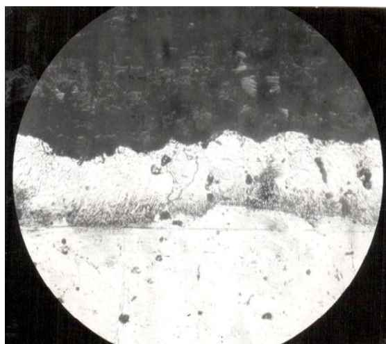
Рисунок 4 – Мікроструктура та газонасичений шар за термоциклічного режиму по трапецеїдальному циклу за наявності напруження \sigma = 1,2 \cdot 10^7 Па
