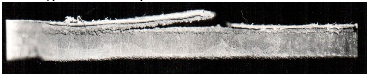
Рисунок 8 – Особливості адгезійного відшарування покриття \text{Al}_2\text{O}_3 + 13\% \text{TiO}_2 від основи титанового сплаву VT5-1
